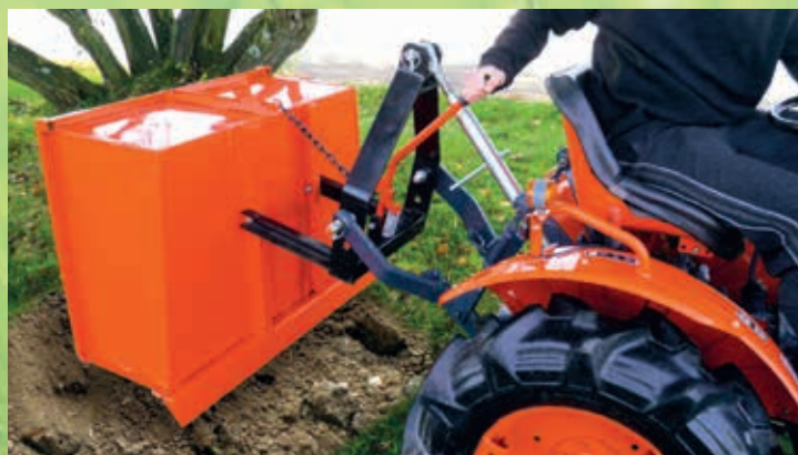
BENNETTE 100 Basculement mécanique. Porte arrière à double ouverture. Lame robot. Capacité de relevage 550 kg. Largeur 1 m : 70 kg.
